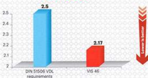
Oxidation test PNEUROP CCR, (%WT) DIN 51352-2
